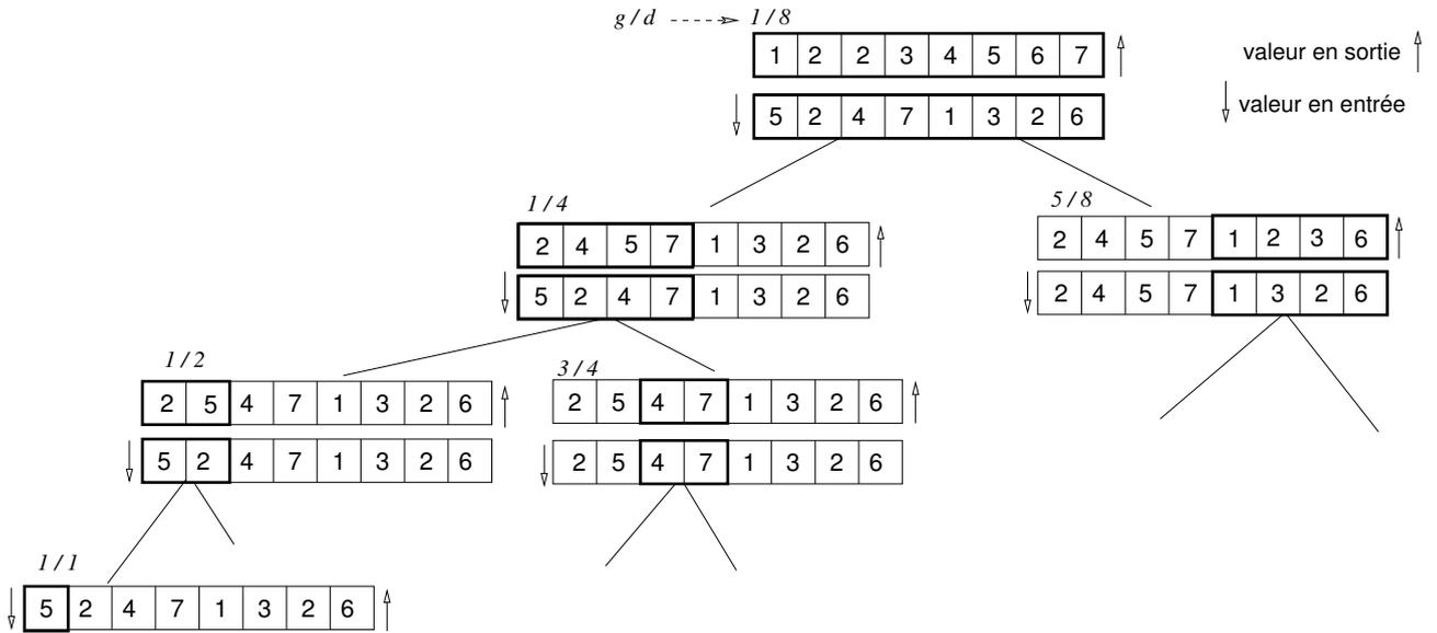
FIG. 1 – Exemple d'exécution du tri fusion (détail)
