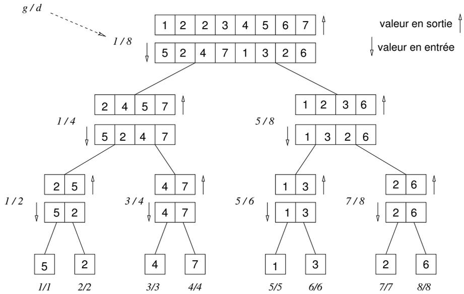
FIG. 2 – Exemple d'exécution du tri fusion (complet)
